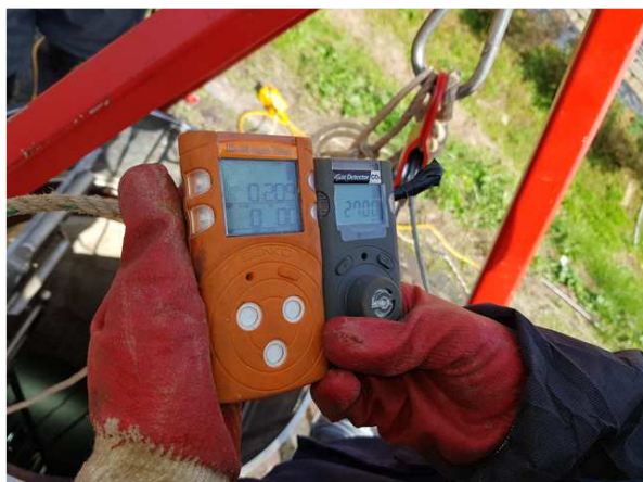
내용 출입전 산소 농도 측정
